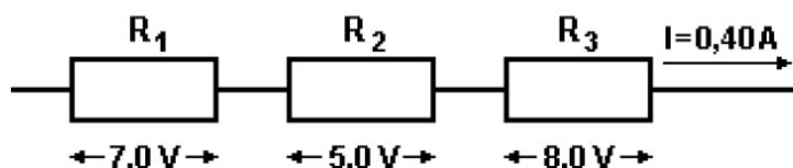
Determine o resistor equivalente dessa associação, em ohms.
