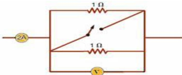
O voltímetro está ligado em paralelo com uma das resistências.
